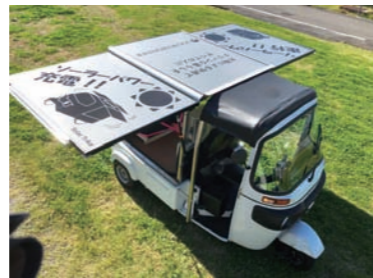
ソーラーパネルを搭載した「ソーラートライク」。太陽光発電のみで走行可能。
